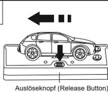
Entnehmen Sie den Sender und das Auto. Drücken Sie den Auslöseknopf und ziehen Sie das Auto in die angegebene Richtung um es von der Halteplatte zu lösen.
