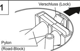
Öffnen Sie die Dose, indem Sie den Deckel abnehmen. Drücken Sie den Verschluss in die angegebene Richtung und entnehmen Sie die 4 Pylonen.
