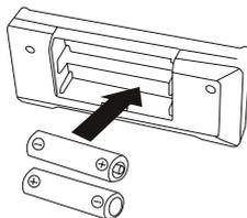
Legen Sie 2 x AA Batterien (nicht im Lieferumfang enthalten) in das Batteriefach ein und schließen Sie den Deckel wieder.
