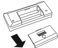
Schieben Sie beim Sender den Deckel des Batteriefachs in die gezeigte Richtung, um es zu öffnen. Slide the transmitter's battery compartment cover towards the direction shown and open it.
